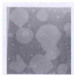
Fig.11 SP120N Substrate layer bubbling
